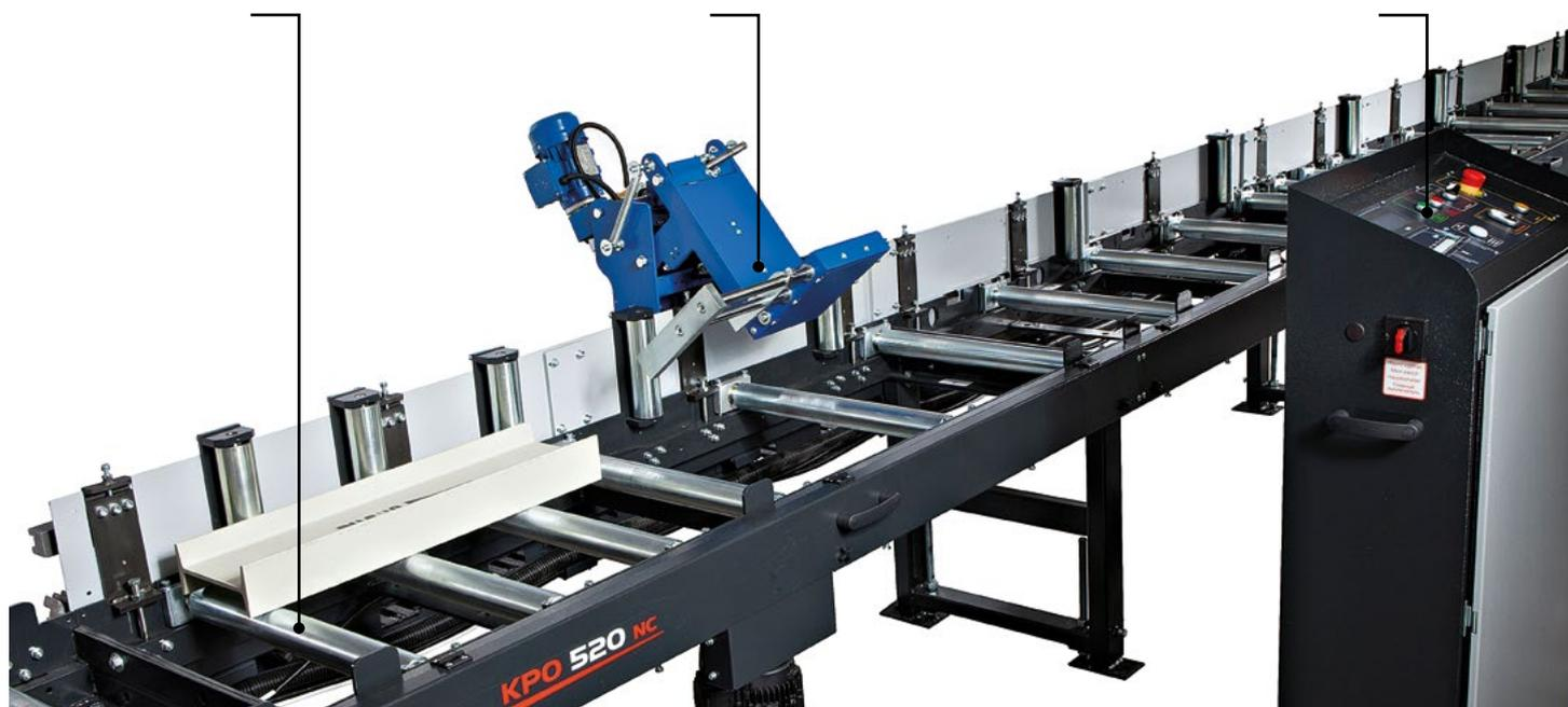
Ролики с приводом от двигателя позволяют точно перемещать любой материал, плавная регулировка частоты вращения с помощью частотного преобразователя обеспечивает плавный пуск и точную установку подаваемого материала. Жесткая сварная конструкция, как и на всех конвейерах системы К и R. Роликовые валы установлены в регулируемых стальных опорах с подшипниками. Отдельные модули взаимно-соединяются и позволяют настраивать оптимальную длину конвейера. Высота рольганга регулируется.
