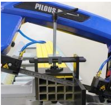
Прижим вертикальный ручной, VP 300
