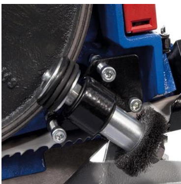
Щетка для снятия стружки, KDM
