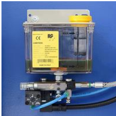
Распыление масляного тумана, MM
