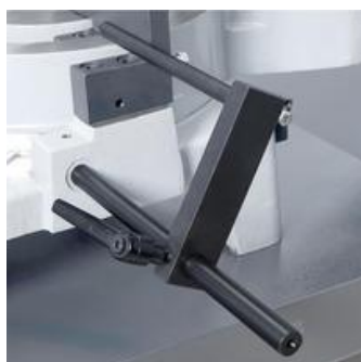
Упор для выставления заготовок, длиной 250 мм, DR
