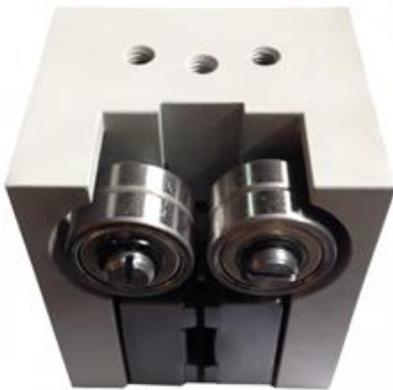
Движение пилы в зоне резания обеспечивается одной подвижной и двумя неподвижными направляющими, в которых лента движется между подшипниками и гидравлически регулируемые твердосплавными пластинами. Подвижная направляющая перемещается автоматически вместе с подвижной губкой тисков как можно ближе к заготовке, обеспечивая максимальную жесткость и точность выставления пилы при резании.
