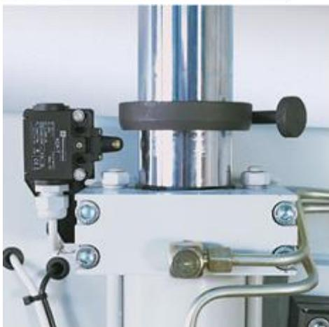
Станок оснащен устройством контроля высоты поднятия рамы.
