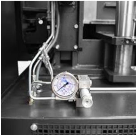
Устройство ограничения давления в тисках с индикатором давления в комплекте.
