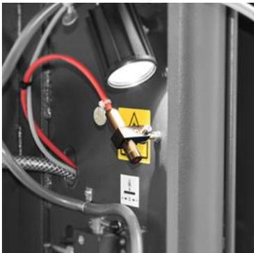
Лазерный указатель линии реза.
