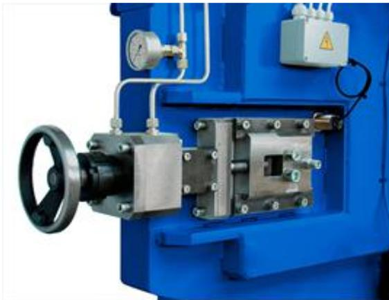
Гидравлическое устройство натяжения ленточной пилы с манометром обеспечивает оптимальное усилие натяжения полотна при работе и Натяжение ленточной пилы до 45 бар
