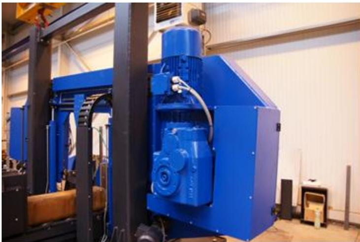
Главный привод выполнен на основе частотно-управляемого асинхронного электродвигателя с и червячным редуктором для жестких условий эксплуатации. Скорость движения ленты можно плавно изменять, что обеспечивает возможность качественной обработки практически всей гаммы материалов от «легких» до специальных и «тяжелых» металлов и сплавов.
