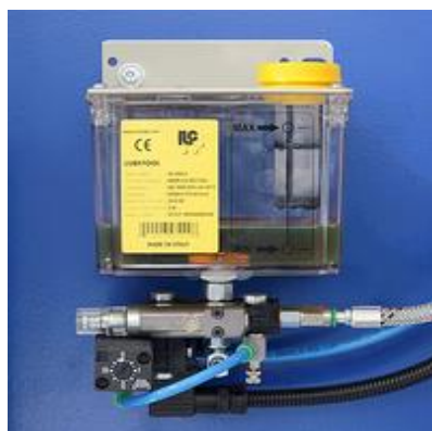
Распыление масляного тумана, MM
