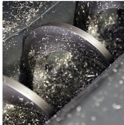
Конвейер для сбора стружки, SD
