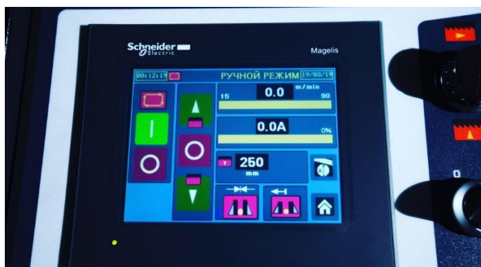
Ручной режим Можно управлять функциями станка по отдельности.
