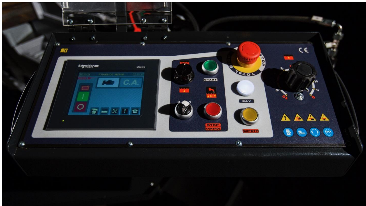
Эргономичная панель управления, большой сенсорный дисплей 7.5-дюйма производства Schneider electric. Позволяет просто и интуитивно управлять всеми функциями станка.
