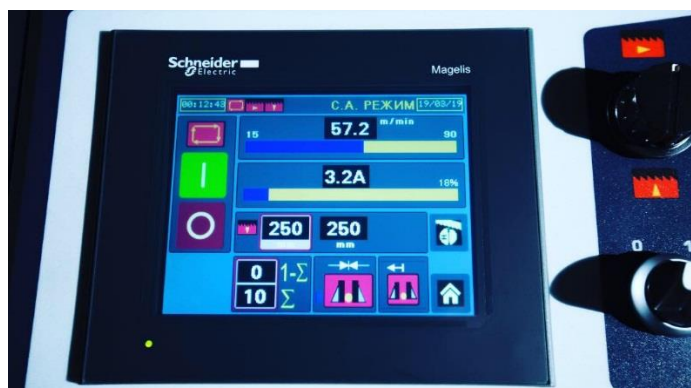
Основное меню полуавтоматического режима. В процессе резания на дисплее отражается число отрезанных заготовок, скорость пилы, нагрузка на главный двигатель, время с начала цикла и оставшееся.
